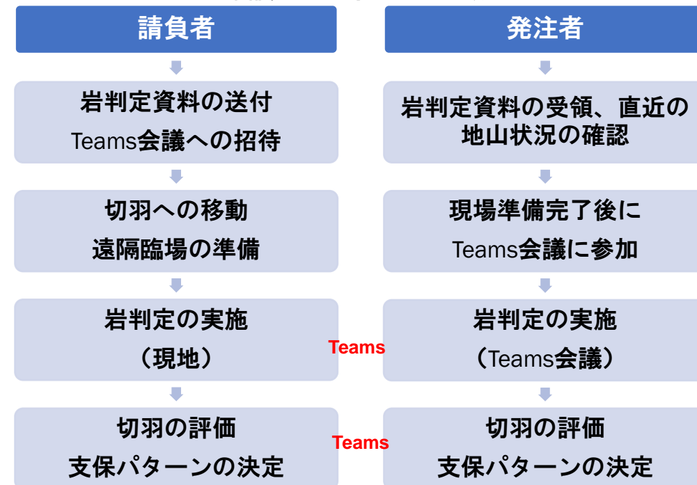
遠隔臨場による岩判定の手順フロー
